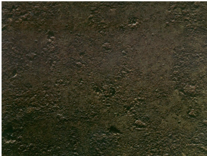
Preparation grades. Blast cleaning D Sa 1
