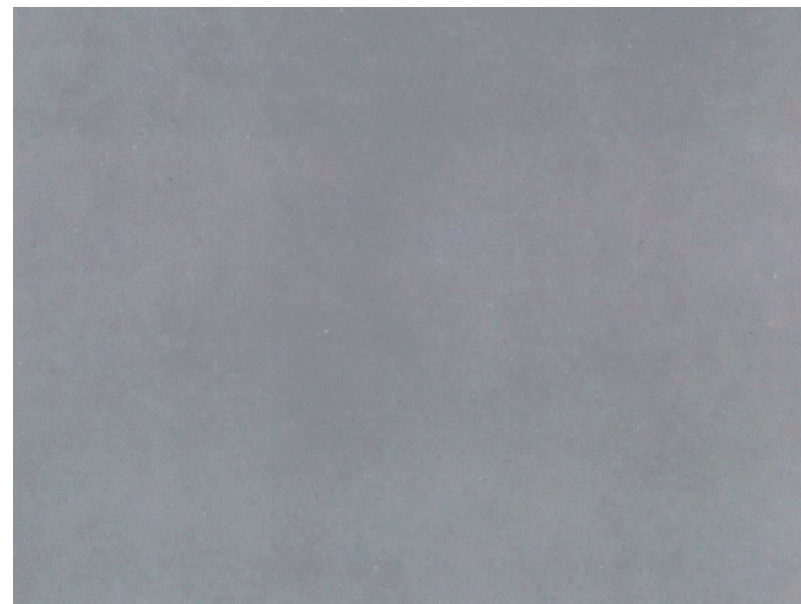
Preparation grades. Blast cleaning A Sa 3
