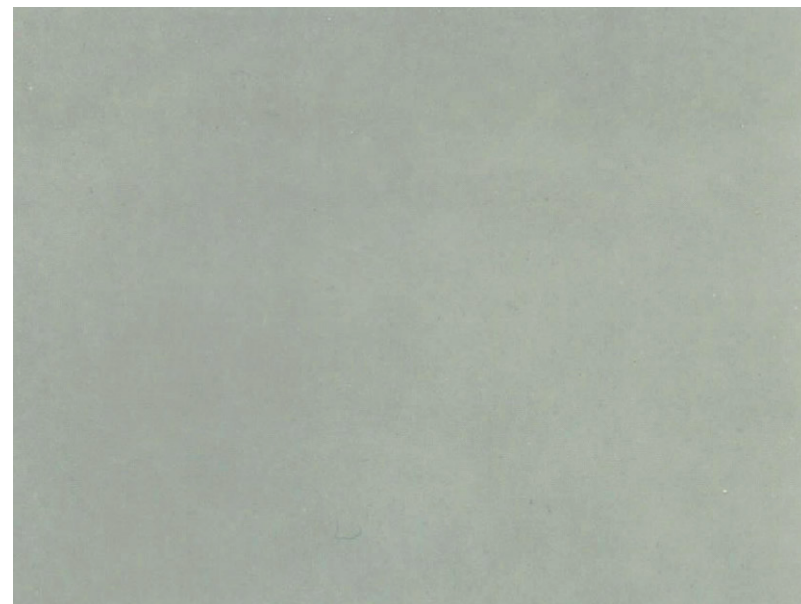
Preparation grades. Blast cleaning C Sa 3
