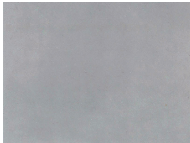
Preparation grades. Blast cleaning B Sa 3
