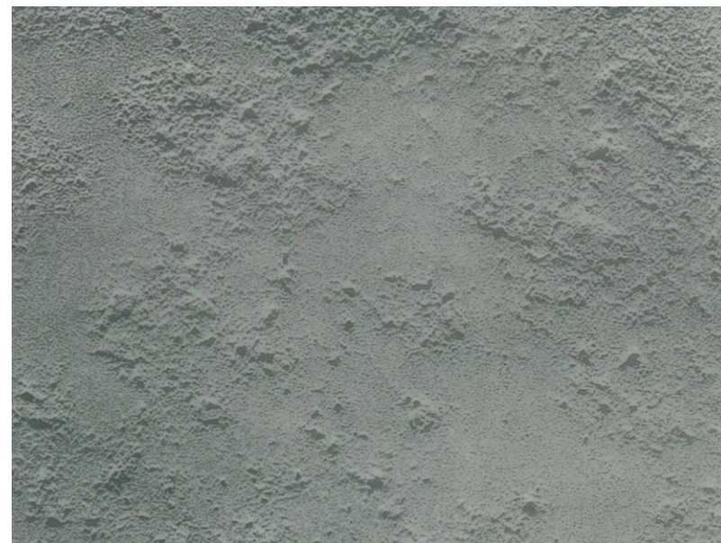
Preparation grades. Blast cleaning D Sa 3
