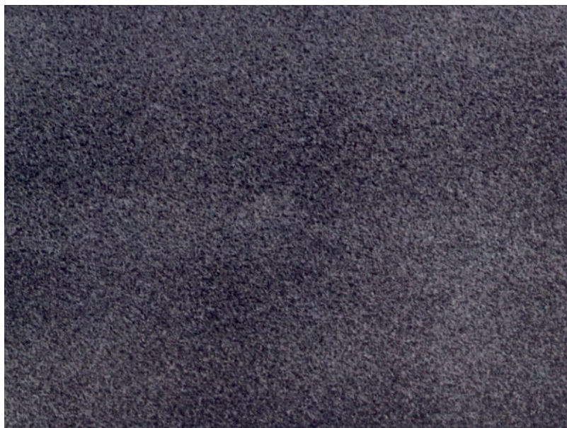
Preparation grades. Blast cleaning C Sa 2
